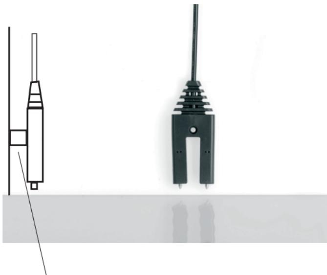
*Abstandshalter: Sensoren mit einem Abstand von min. 1 cm zum Befestigungsuntergrund montieren, damit anhaftende Flüssigkeiten ablaufen können.*
